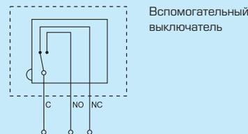
Привод с предварительно установленным вспомогательным выключателем, Арт. номер.
