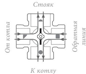
**ПРИНЦИП ДЕЙСТВИЯ 5-ХОДОВЫХ КЛАПАНОВ**
