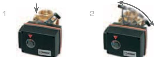
1 Для управления клапаном вручную, нажмите кнопку и переведите рычаг. Электрический ток будет автоматически отключен до тех пор, пока кнопка находится в нижней позиции.
