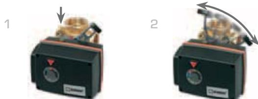
1 Для управления клапаном вручную, нажмите кнопку и переведите рычаг. Электрический ток будет автоматически отключен до тех пор, пока кнопка находится в нижней позиции.
