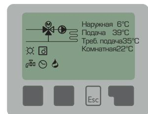
Скорректированная кривая отопления используется для достижения наиболее комфортной температуры в различных помещениях.
